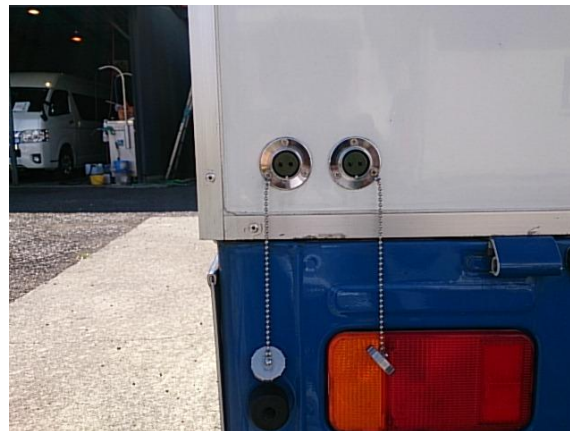
■ 外部電源引込口
